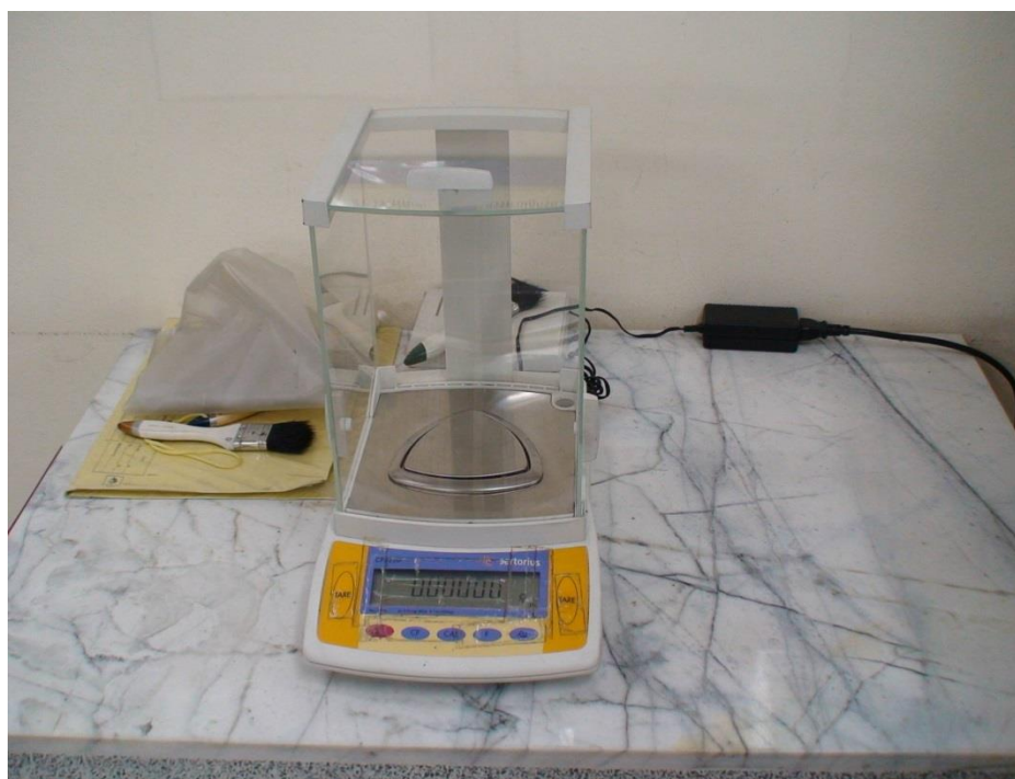
รูปที่ ก.23) เครื่องชั่งไฟฟ้าแบบละเอียด ทศนิยม 5 ตำแหน่ง
