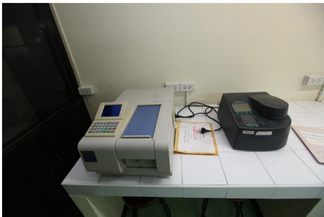
รูปที่ ก.29) เครื่อง UV-Visible Spectrophotometer (Single beam)
