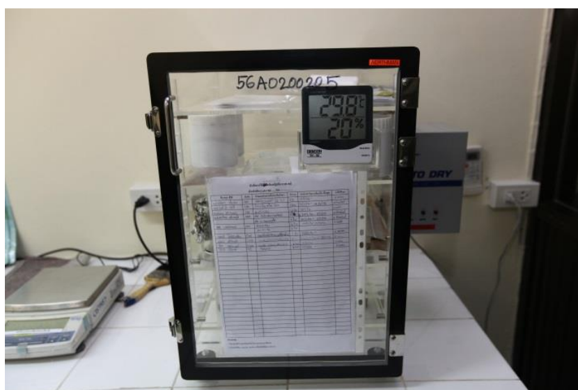
รูปที่ ก.36) ตู้ควบคุมความชื้น (Moisture control cabinet)
