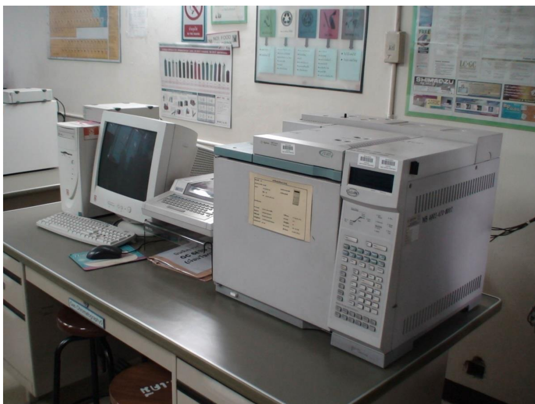
รูปที่ ก.20) เครื่อง Gas Chromatography (GC) with TCD
