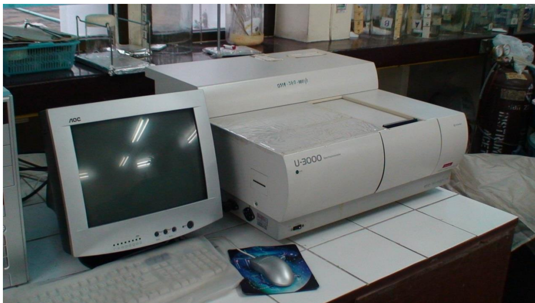
รูปที่ ก.28) เครื่อง UV-Visible Spectrophotometer (Double beams)
