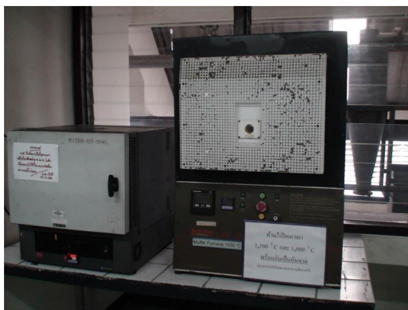
รูปที่ ก.46) เตาเผาไฟฟ้าชนิด Muffle Furnace อุณหภูมิ 1,100°C
