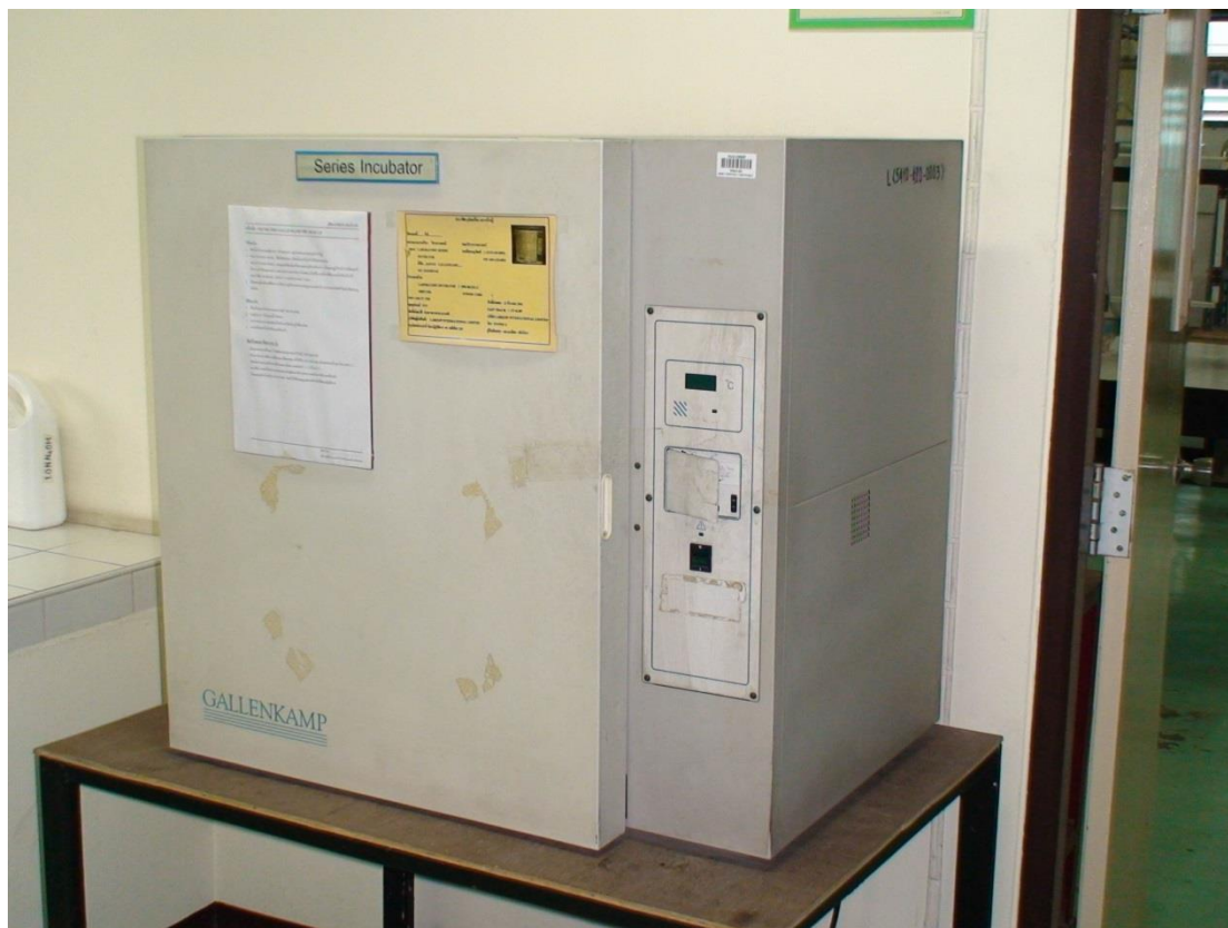
รูปที่ ก.53) ตู้ควบคุมอุณหภูมิ (Incubator) 20°C, 37°C และ 50°C
